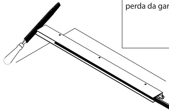
Retirar as rebarbas deixadas pelo corte com uma lima, lixa fina ou estilete. Retornar o perfil vedante para o lado do corte, cortar a sobra, deixando + ou - 1 cm de cada lado.
