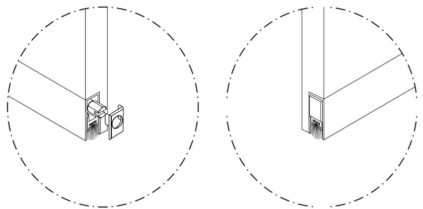
Após a regulagem, coloque as tampas de acabamento nas extremidades do Veda Porta Automático.
