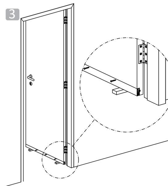
Coloque o Veda Porta Automático no rebaixo, deixando-o no mesmo nível da parte inferior da folha da porta, com o pino acionador voltado para o lado da dobradiça (Utilize calços para mantê-lo posicionado) e faceando nos topos da porta.
