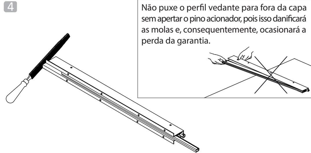
Retirar as rebarbas deixadas pelo corte com uma lima, lixa fina ou estilete. Retornar o perfil vedante para o lado do corte, cortar a sobra, deixando +ou-1cm de cada lado.
