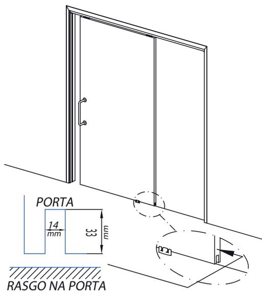
Abra um canal na parte inferior da porta em toda sua extensão, 14mm de largura por 33mm de topo a topo. Esse passo deverá ser realizado por um profissional treinado, pois exige a remoção da porta e a utilização de uma máquina de corte profissional.
