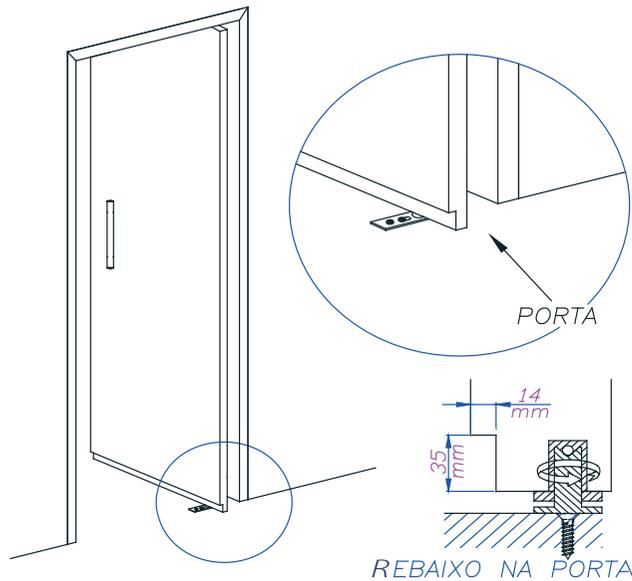
Faça um rebaixo na porta na face externa (do lado de fora), nas medidas 14mm de profundidade por 35mm ao longo da largura da folha da porta. Caso a porta esteja já instalada, esse passo deverá ser realizado por um profissional treinado, pois exige a remoção da mesma e a utilização de uma máquina de corte profissional.
