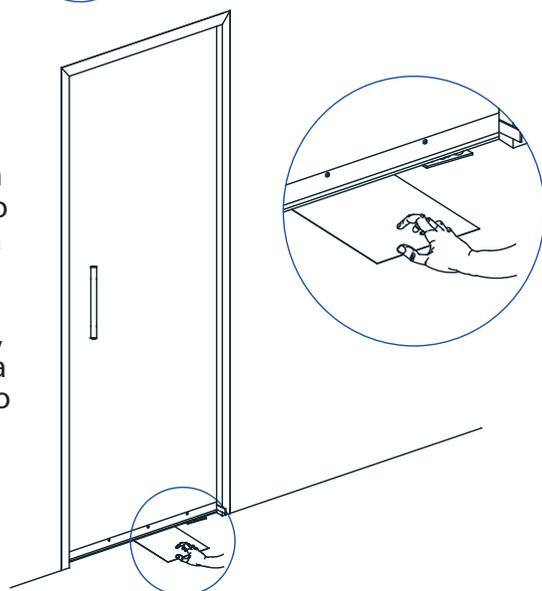
**Atenção:** A viabilidade da instalação do Veda Porta Automático semi-embutido em portas de alumínio, acm, aço, ferro ou pvc deverá ser analisada pelo fabricante das esquadrias.
