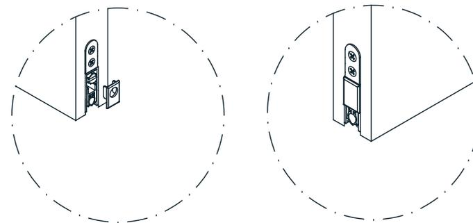
Após a regulagem, coloquē as tampas de acabamento nā extremidades do Veda Porta Automático.
