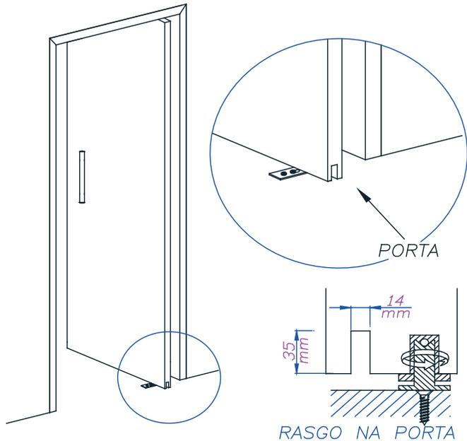
Faça um canal na porta, nas medidas 14mm de profundidade por 35mm ao longo da largura da folha da porta. Deslocado do pivô da porta.
