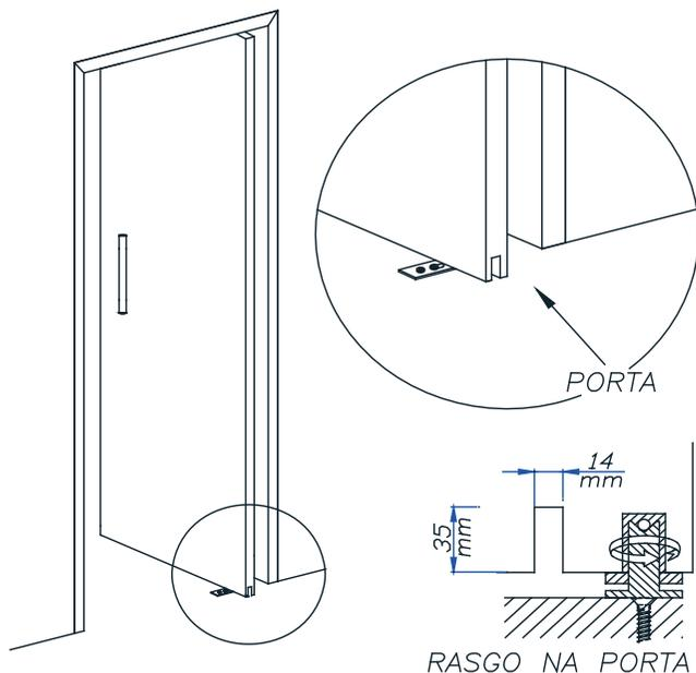
Faça um canal na porta na face externa (do lado de fora), nas medidas 14mm de profundidade por 35mm ao longo da largura da folha da porta.
