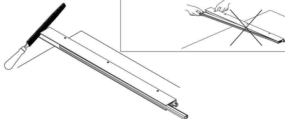
Retirar as rebarbas deixadas pelo corte com uma lima, lixa fina ou estilete. Retornar o perfil vedante para o lado do corte, cortar a sobra, deixando + ou - 1 cm de cada lado.
