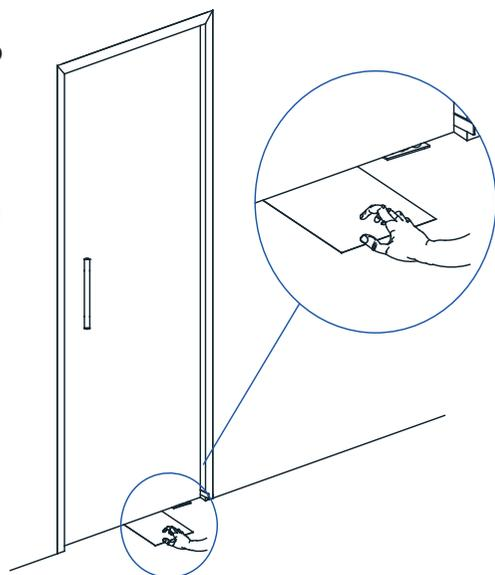
**Atenção:** A viabilidade da instalação do Veda Porta Automático semi-embutido em portas de alumínio, acm, aço, ferro ou pvc deverá ser analisada pelo fabricante das esquadrias.
