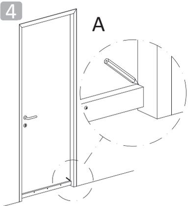
**4** A. Após fixar o Max Veda Porta na folha da porta, marque a posição deste no batente para a colocação da chapa batente.
