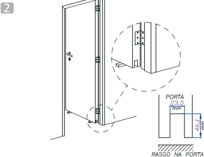
Abra um canal na parte inferior da porta em toda sua extensão, 23,6 mm de largura por 46,1 mm de topo a topo. Esse passo deverá ser realizado por um profissional treinado, pois exige a remoção da porta e a utilização de uma máquina de corte profissional.
