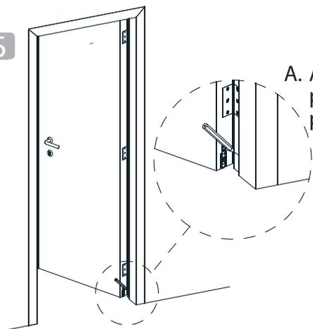
A. Após fixar o Max Veda Porta na folha da porta, marque a posição deste no batente para a colocação da chapa batente.
