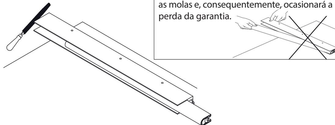
Retirar as rebarbas deixadas pelo corte com uma lima, lixa fina ou estilete. Retornar o perfil vedante para o lado do corte, cortar a sobra, deixando + ou - 1cm de cada lado.
