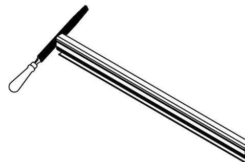
Em seguida, retire as rebarbas deixadas pelo corte com uma lixa lima, lixa fina ou estilete.
