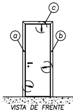
a - Fixe as barras laterais no batente com os parafusos de fixação;
