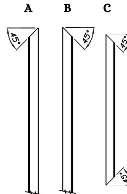
A - Inicie o corte na extremidade da barra lateral, em ângulo de 45°.
