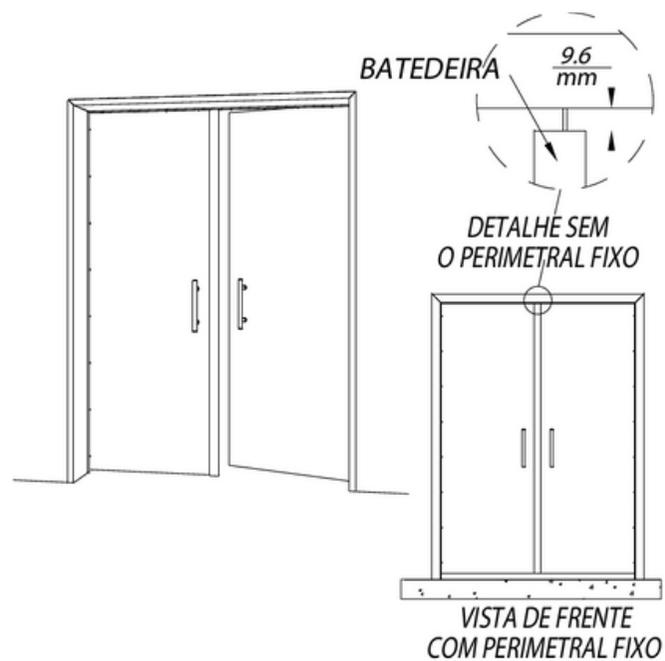
É necessário cortar a bateadeira da folha fixa em 9,6mm, medindo do batente superior para baixo, para que Perimetral Fixo para Batente possa encostar na folha da porta.
