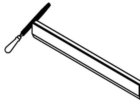
Em seguida, retire as rebarbas deixadas pelo corte com uma lixa lima, lixa fina ou estilete.
