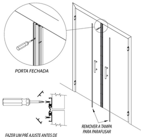
Com a porta fechada, encoste o perfil na lateral da porta, alinhando a extremidade da capa com a vedação com a linha de topo da porta.
