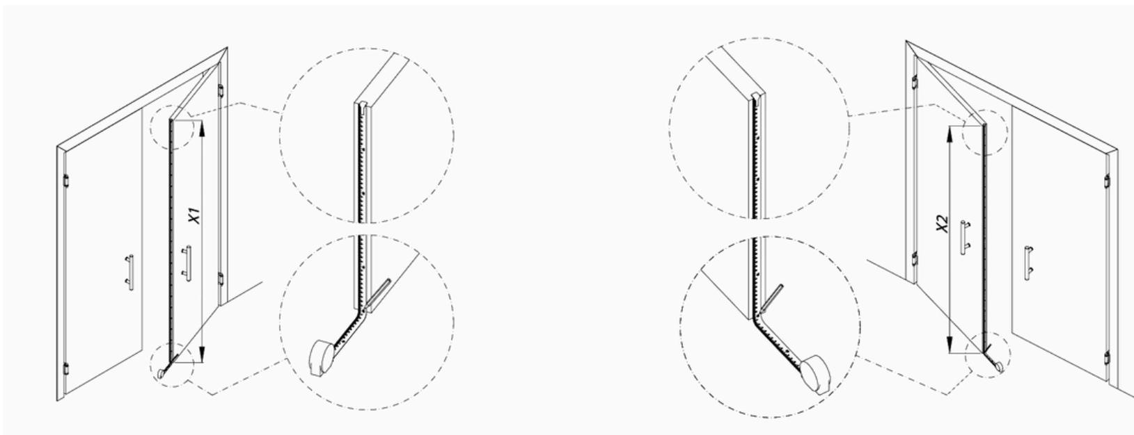
**X1 = Medir a altura da folha da porta, da parte superior até a parte inferior.**
