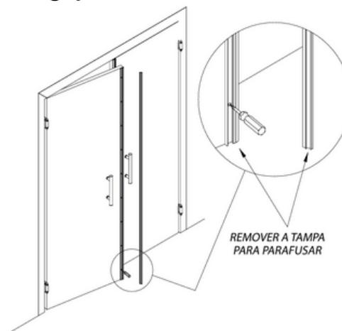
Ajuste as vedações através dos parafusos de ajustes na base do perfil.
