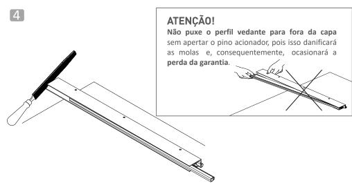
Retirar as rebarbas deixadas pelo corte com uma lima, lixa fina ou estilete. Retornar o perfil vedante para o lado do corte, cortar a sobra, deixando + ou - 1cm de cada lado.
