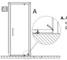
**A.** Após fixar o Veda Porta Automático na folha da porta, marque a posição deste no batente para a colocação da chapa batente.
