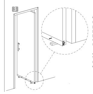
Coloque o Veda Porta Automático no rebaixo, deixando-o no mesmo nível da parte inferior da folha da porta, com o pino acionador voltado para o lado do pivô e faceando nos topos da porta (Utilize calços para mantê-lo posicionado).
