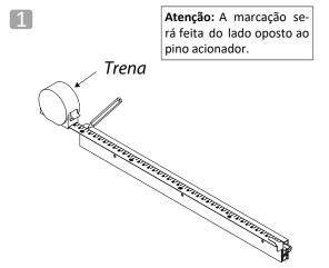
Após a definição do comprimento final, marque com uma trena ou metro a medida encontrada no Veda Porta Automático.
